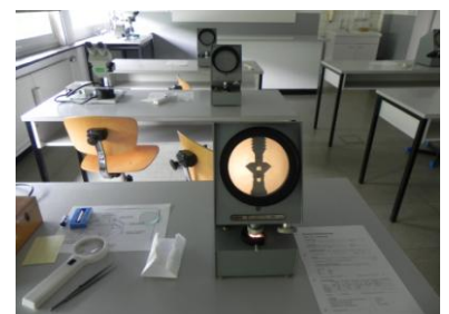
Mit dem Proportionscope lassen sich die Proportionen und einige Symmetriemerkmale bei runden Brillanten und modifizierten Brillantschliffen in Prozent ermitteln.
